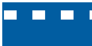
passo 2:1 foro rettangolare 5,5 x 4 mm
