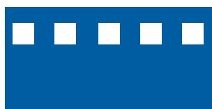
passo 3:1 foro quadro 4 x 4 mm
